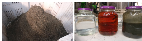
Le tri des constituants du Lisier : une matière solide, une eau pure et deux engrais liquides obtenus après 3 phases de filtrations
