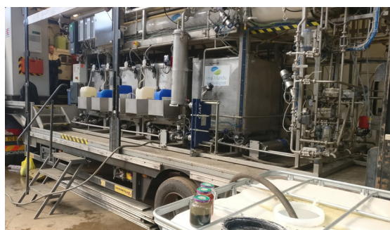
MOBILIS®, une vidange des fosses à lisier combinée à une extraction d'eau et d'engrais.
